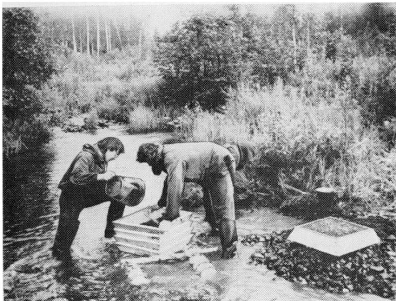
Идет шлиховое опробование речных отложений, рассев рыхлого материала по классам с помощью системы сит Шейкера.
