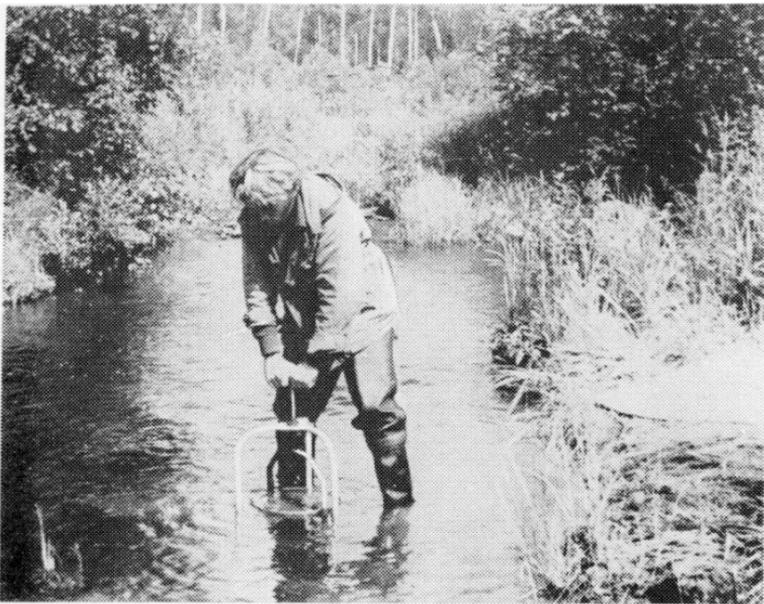
После отсева определенный класс рыхлого материала отсаживается на ручной машинке джиге: авось сверкнет что-нибудь стоящее...
